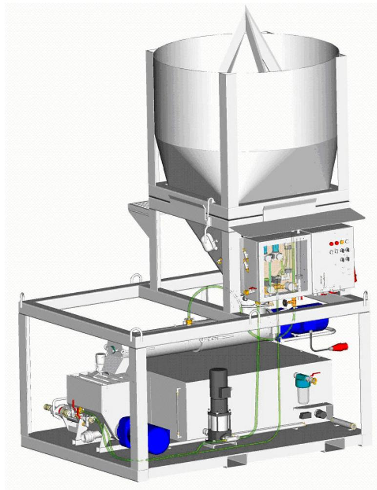
Diese kompakte Anlage hat alles an Bord um unabhängig zu sein von schwankendem Wasserdruck im Netz. Ebenso aufgebaut ein Schrank für Zubehör und Werkzeug. Gute Zugänglichkeit und schnelle Abreinigung sind gegeben.
